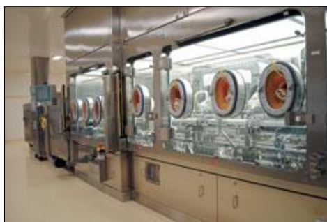
Figure 10: exemple de "boîte à gant" pour remplissage aseptique
