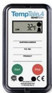
Figure 22: illustration d'un temp tale pour le suivi des températures
