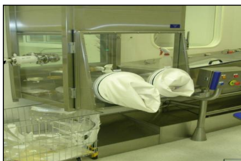
Figure 17: exemple de boîte à gant permettant le retrait des sachets des composants stériles
