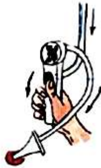
9 Ouvrir le régulateur de débit afin de laisser l'eau s'écouler
