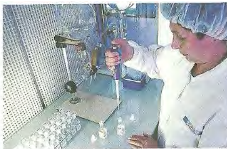
La dilution est préparée sous enceinte à flux d'air laminaire.
