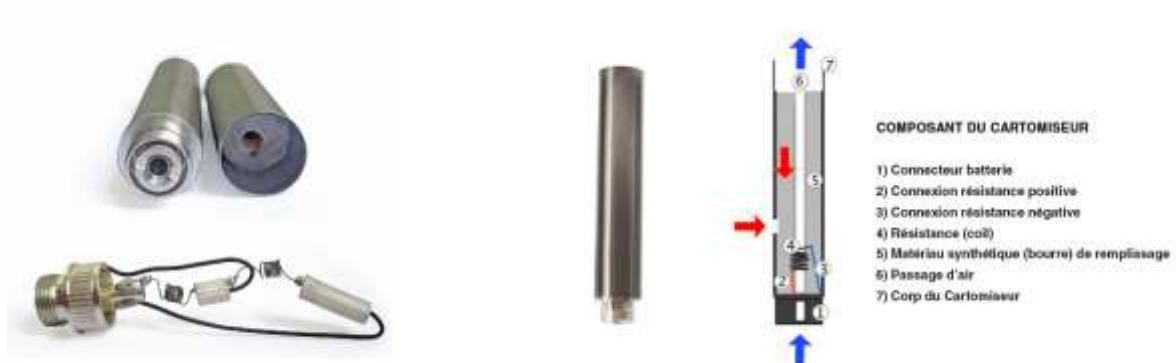
Figure 6 : Cartomiseur double résistance ou dual coil (à gauche) (d'après http://lesdossiersdevlad.blogspot.fr/ ) et anatomie d'un cartomiseur (à droite) (d'après http://forum.aromes-et-liquides.fr/forum/cartomiseurs-f111/f16-decouverte-t8697.html )
