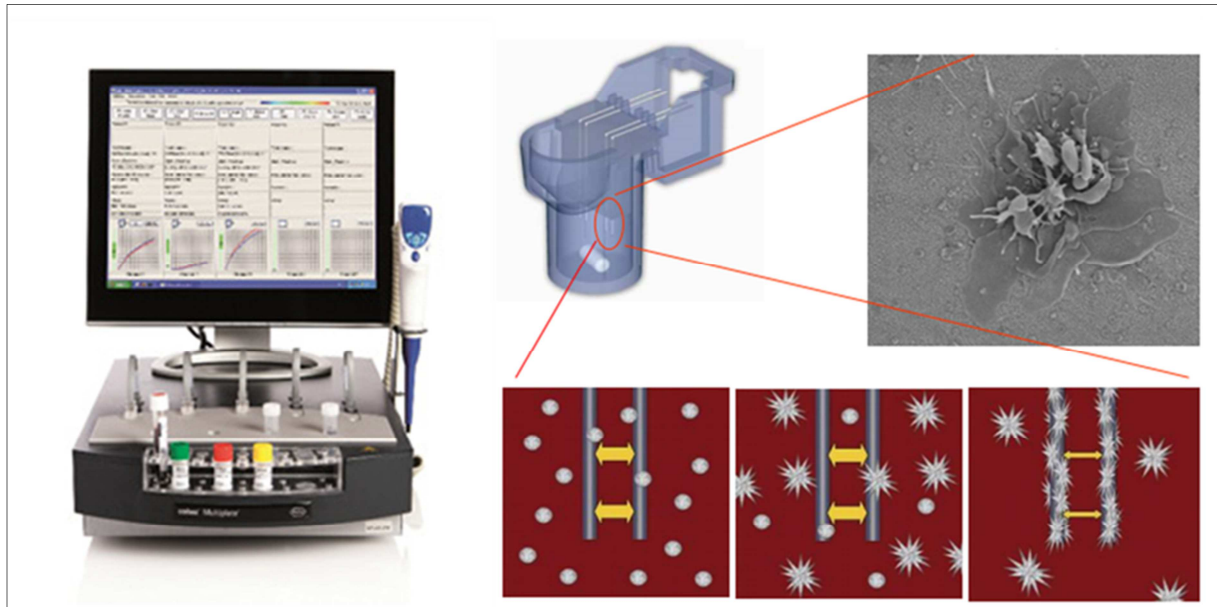
Figure 9 : Système Multiplate ® Analyzer (à gauche) et description d'une cellule de mesure (à droite) 59
