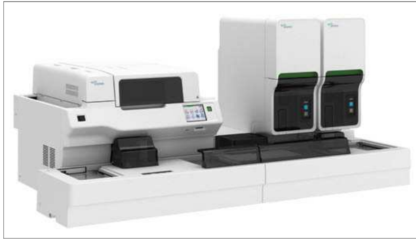
Figure 8 : Automate Sysmex XN 3000 ® ; de gauche à droite : l'étaleur colorateur SP-10 et les deux modules XN 10 ® et XN 20 ®
