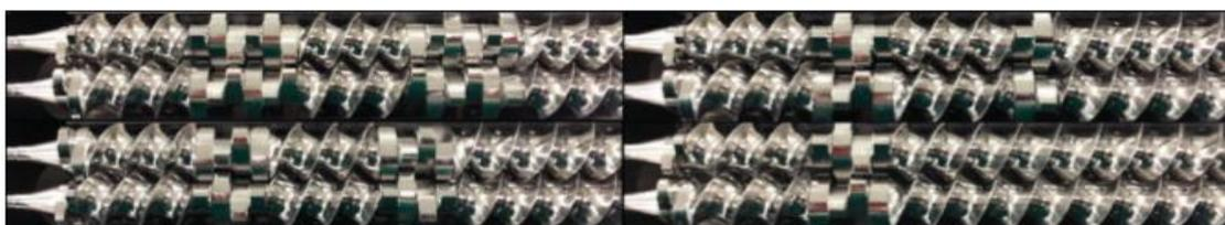
**Figure 24 : Configurations des vis sans fin; 6k6k (haut à gauche), 4k4k (bas à gauche), 4k2k (haut à droite) et 4k (bas à droite).**
