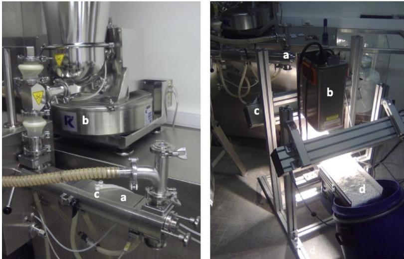
Unité de granulation de Consigma <sup>TM</sup>: Ce granulateur en continu à cisaillement élevé est constitué d'une double vis (Twin Screw) (a) d'un capteur de perte de poids (K-Tron KT20) (b) et du chargeur gravimétrique de liquide (c).
