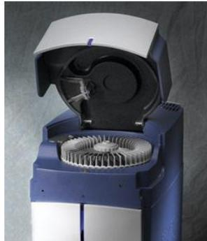
**Figure 18. Automate de scannage des biopuces.**
