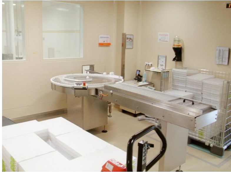
Figure 2 : Table de chargement des flacons.
