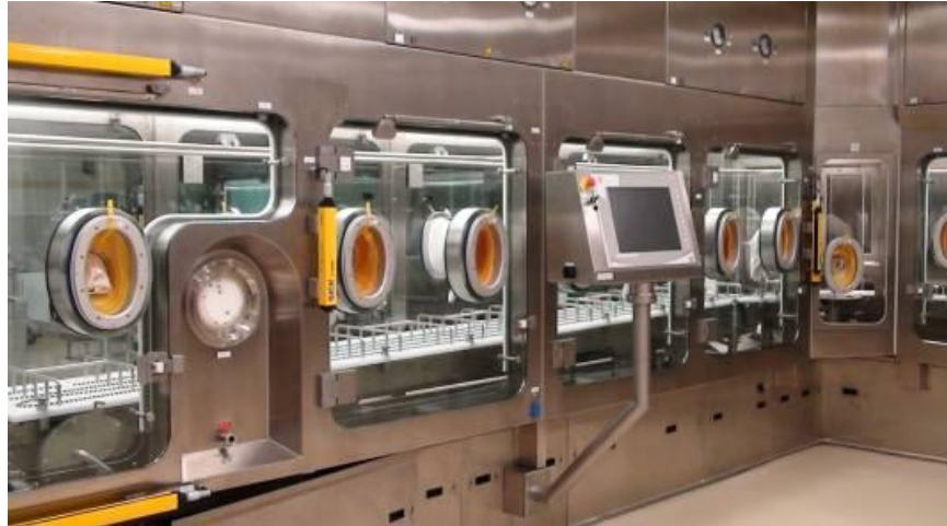
Figure 14 : Isolateur servant de zone tampon.
