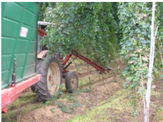
Figure 18 : Tracteur munie de sa machine coupant les tiges [52]
