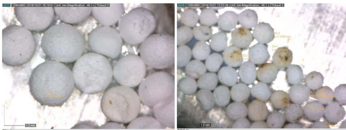
Figure 77 : Population de microgranules de cellulose obtenus par caléfaction d'une solution de cellulose microcristalline et d'acide ascorbique.
