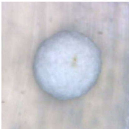
Figure 74 : Microgranule de cellulose obtenu par caléfaction d'une solution de cellulose microcristalline à 30 g.L -1 .
