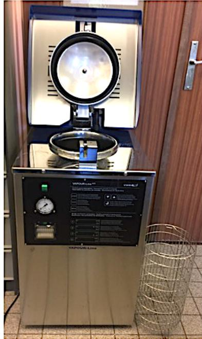
**Figure 1** : Autoclave de paillasse, VAPOUR-Line® (VWR, Radnor, Pennsylvanie, Etats-Unis)
