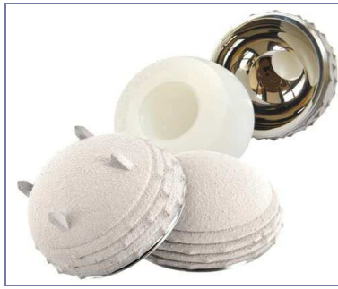
Figure 11 : Cotyle Captiv® DM (Evolutis) : non cimenté, non perforé, stabilité primaire par effet press-fit améliorée par la présence de picots sur la surface externe.
