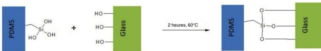
Figure 44 : Schéma représentant la réaction ayant lieu entre le PDMS et le verre
