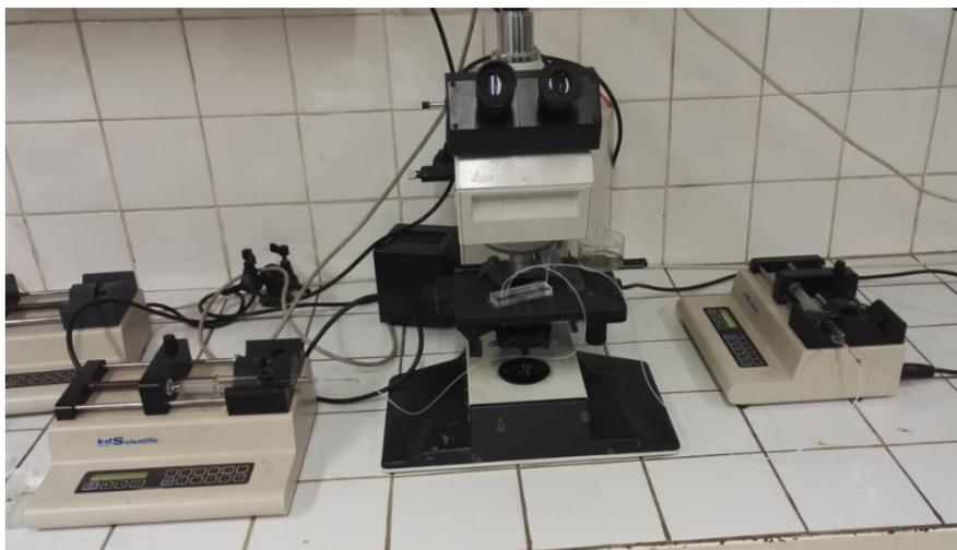
Figure 69 : Fabrication d'émulsions simples, huile dans eau
