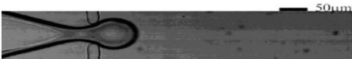
Figure 29 : Régime d'écoulement: "Regime Squeezing"
