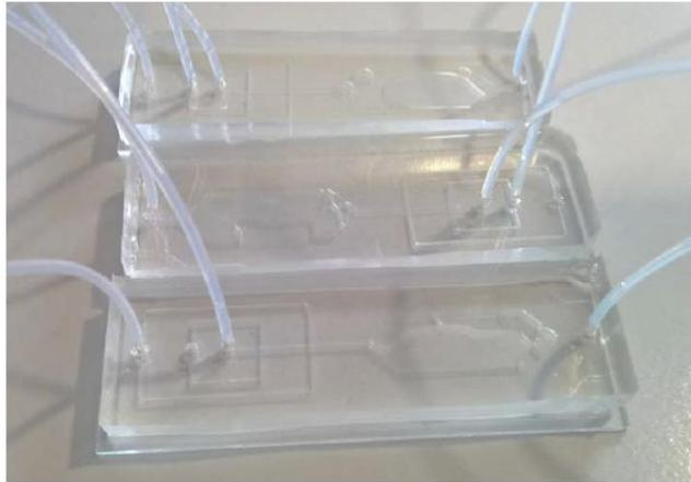
Figure 45 : Microcanaux obtenus à l'issue de l'étape de fabrication
