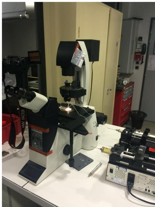
Figure 48 : Fabrication d'émulsions simples eau dans huile
