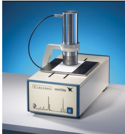
Figure 34. Exemple d'appareil qui permet la mesure des rayonnements gammas
