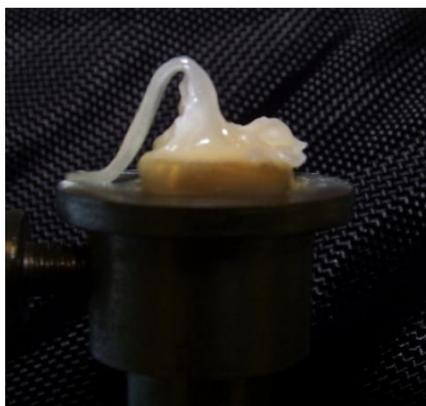
Figure 42: Illustration d'une rupture de type cohésive.
