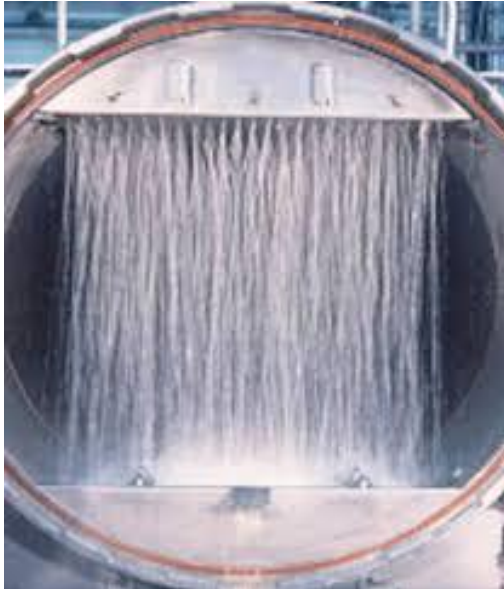
Figure 11 - Vue intérieure d'un pasteurisateur de (19)
