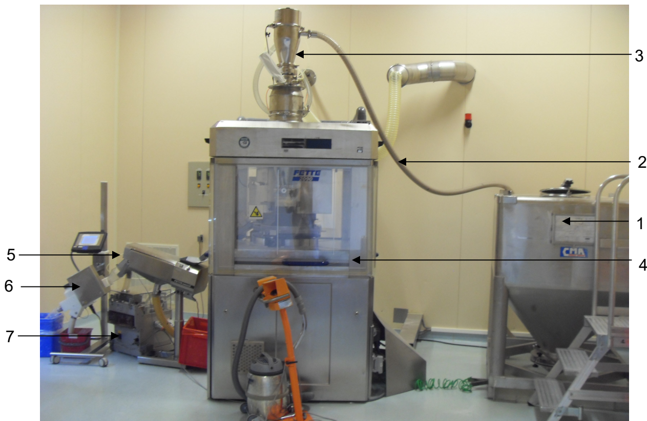
Figure 2 : Organisation d'une salle de compression
