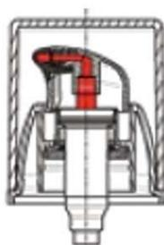
Figure 36 : Schéma d'un dispensateur airless(91)
