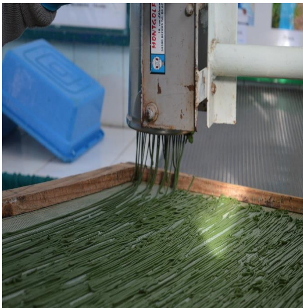
Figure 35 : Biomasse transformée sous forme de spaghettis par l'extrudeuse
