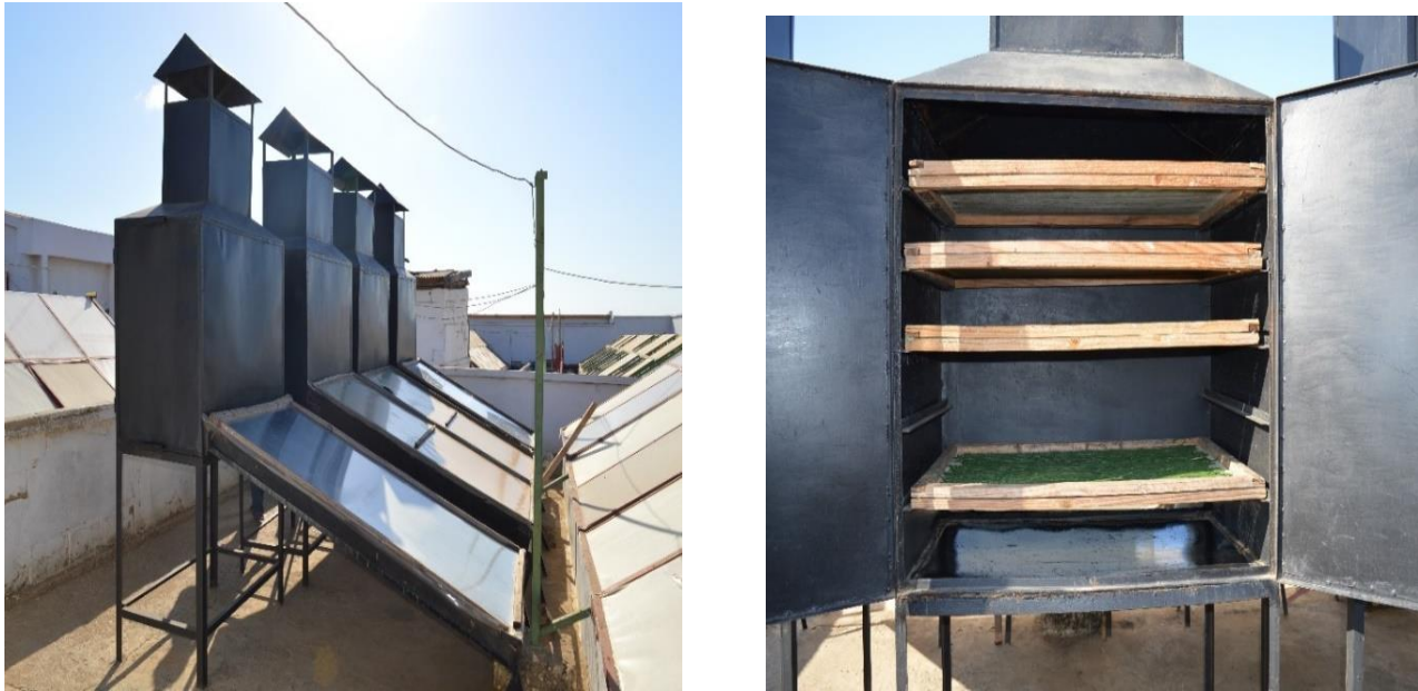
Figure 36 : Séchage de la spiruline dans un séchoir solaire
