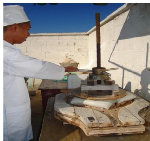
Figure 33 : Pressage par une presse à vis
