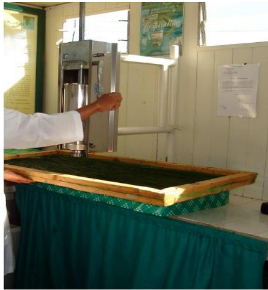
Figure 34 : Extrudeuse de capacité d'environ 5 kg de biomasse fraîche
