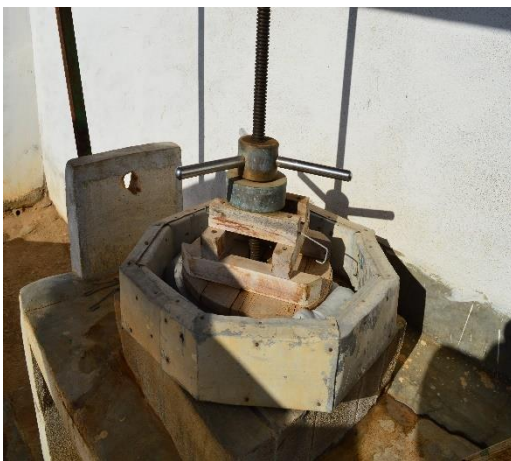
Figure 33 : Pressage par une presse à vis
