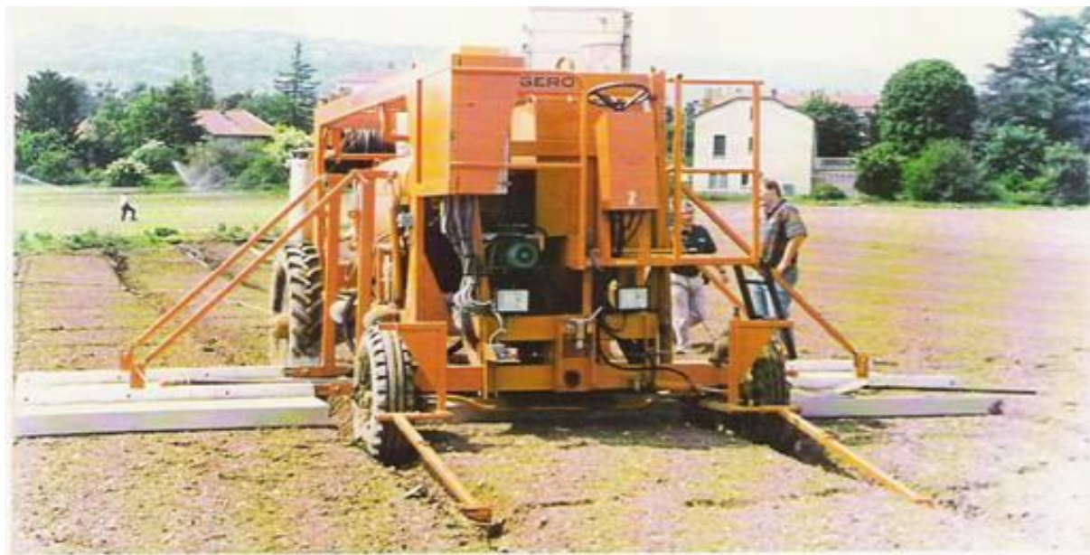
Figure 47: Photo d'un automate Regero permettant la désinfection à la vapeur des sols
