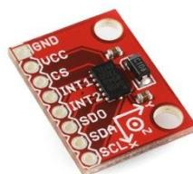
Figure 6: Accéléromètre
