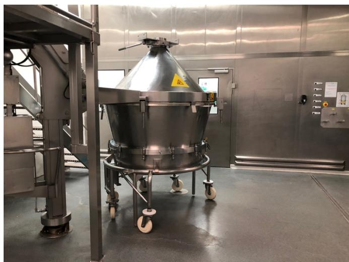
**Figure 11.** Photographie de la cuve produit d'un Lit d'Air Fluidisé avec le cône retourneur en place.
