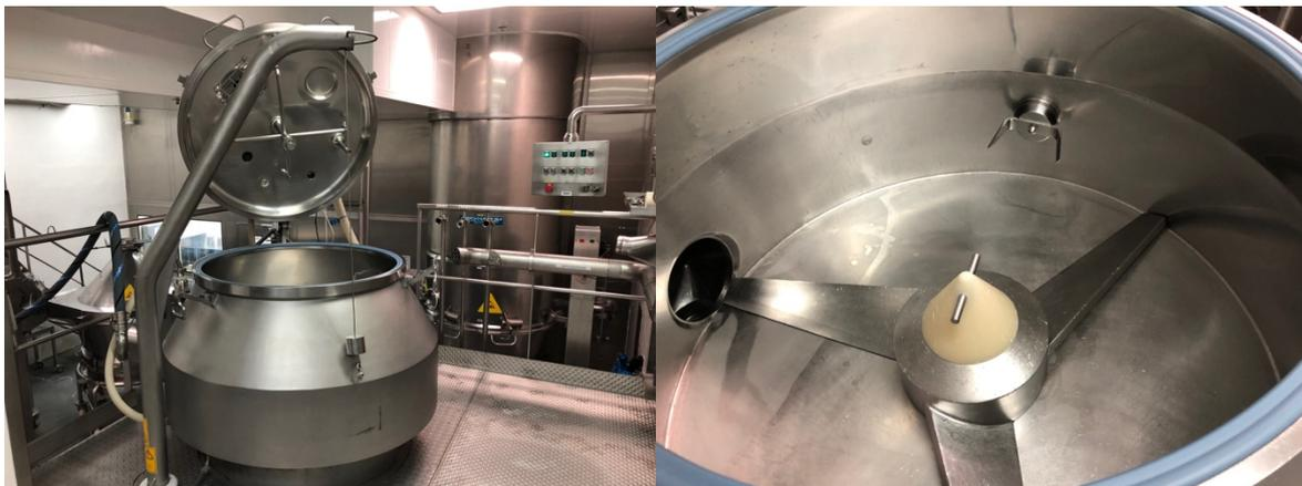
**Figure 6.** Photos d'un granulateur Fielder (à droite l'extérieur du granulateur et à gauche l'intérieur de la cuve).
