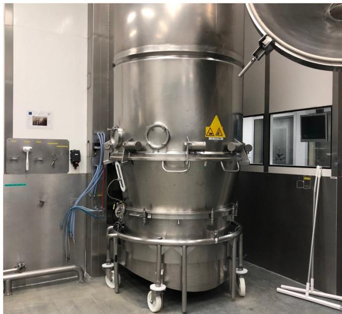
**Figure 8.** Photographie d'un Lit d'Air Fluidisé AEROMATIC®.
