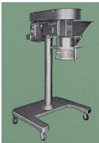
**Figure 2.** Photographie d'un granulateur rotatif classique fabriqué par Colton® (8).
