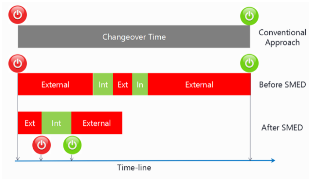
Figure 24 : Simplification du temps de changement par le SMED
