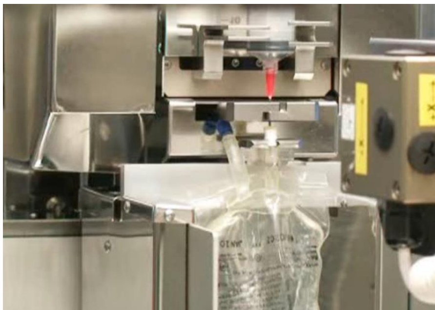
Figure 17 : Photographie du système d'injection RIVA® dans la poche
