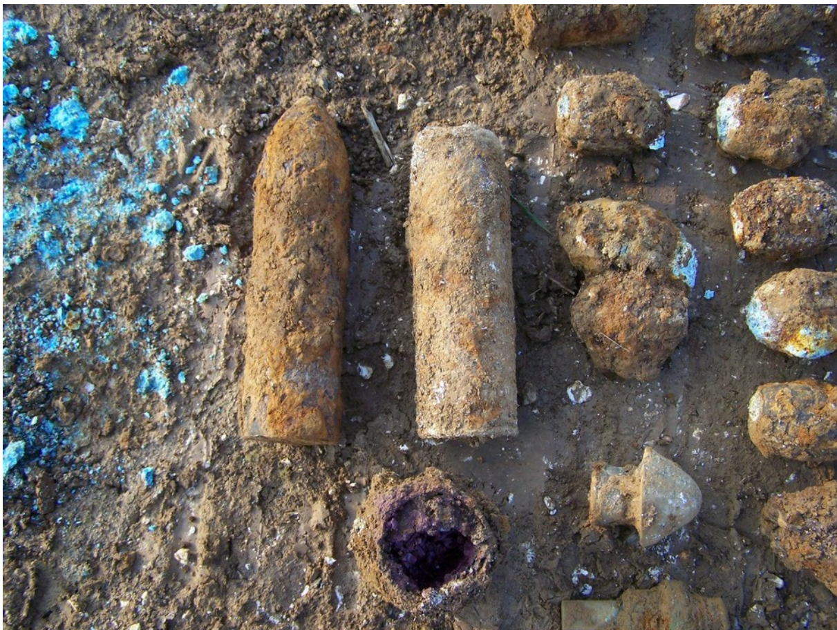
Figure 28 : Grenades et munitions partiellement éclatées avec explosif présentant une corrosion avancée à Vimy (62) (141)
