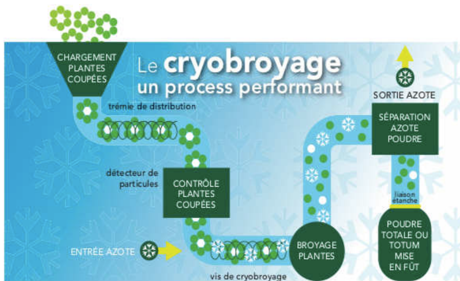
Figure 4 : Méthode de cryobroyage (18)
