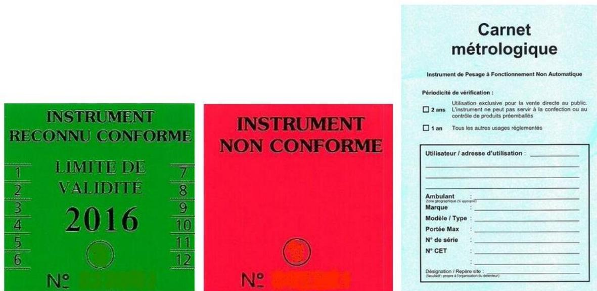
Figure 1 : Exemple de vignettes de contrôle des balances et de carnet métrologique (Source : [www.admpesage.fr](http://www.admpesage.fr))
