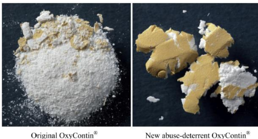
Figure 31 : Apparence physique des comprimés LP d'Oxycontin® originaux (gauche) et ceux avec une nouvelle formulation dissuasive d'abus (droite) après un coup de marteau (68)
