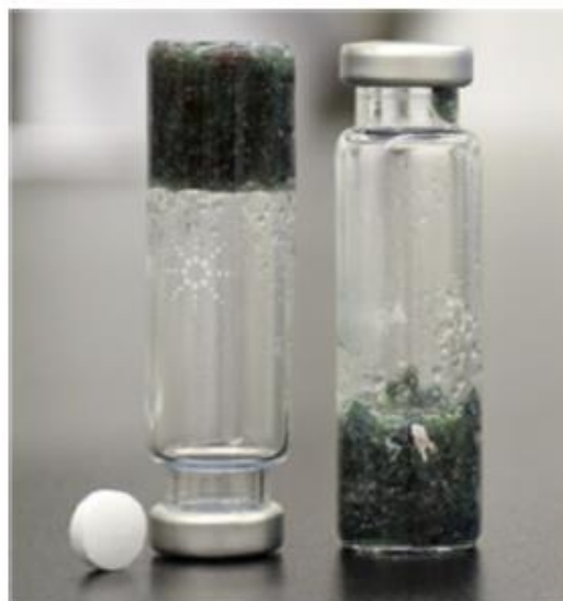
Figure 38 : Absorption du milieu d'extraction et formation d'un gel dur grâce à la technologie Intellitab® (68)
