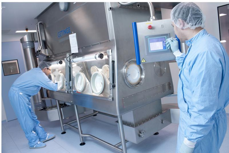
**Figure 29. Exemple d'isolateur (18)**
