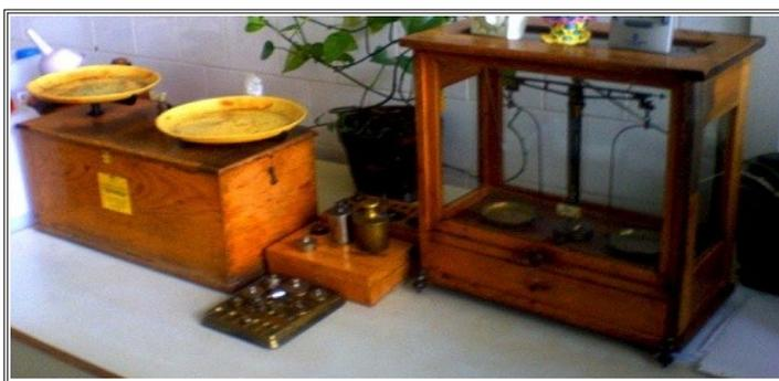
11. Balance de Roberval (à gauche) et un trébuchet de précision (à droite)
