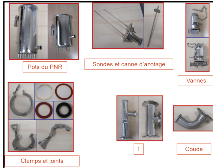
Figure 41: Les différentes pièces composant un Pot à Niveau Régulé.
