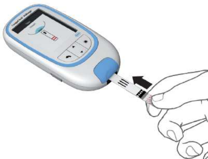
Figure 30: illustration du bon sens d'introduction de la bandelette d'après (52)
