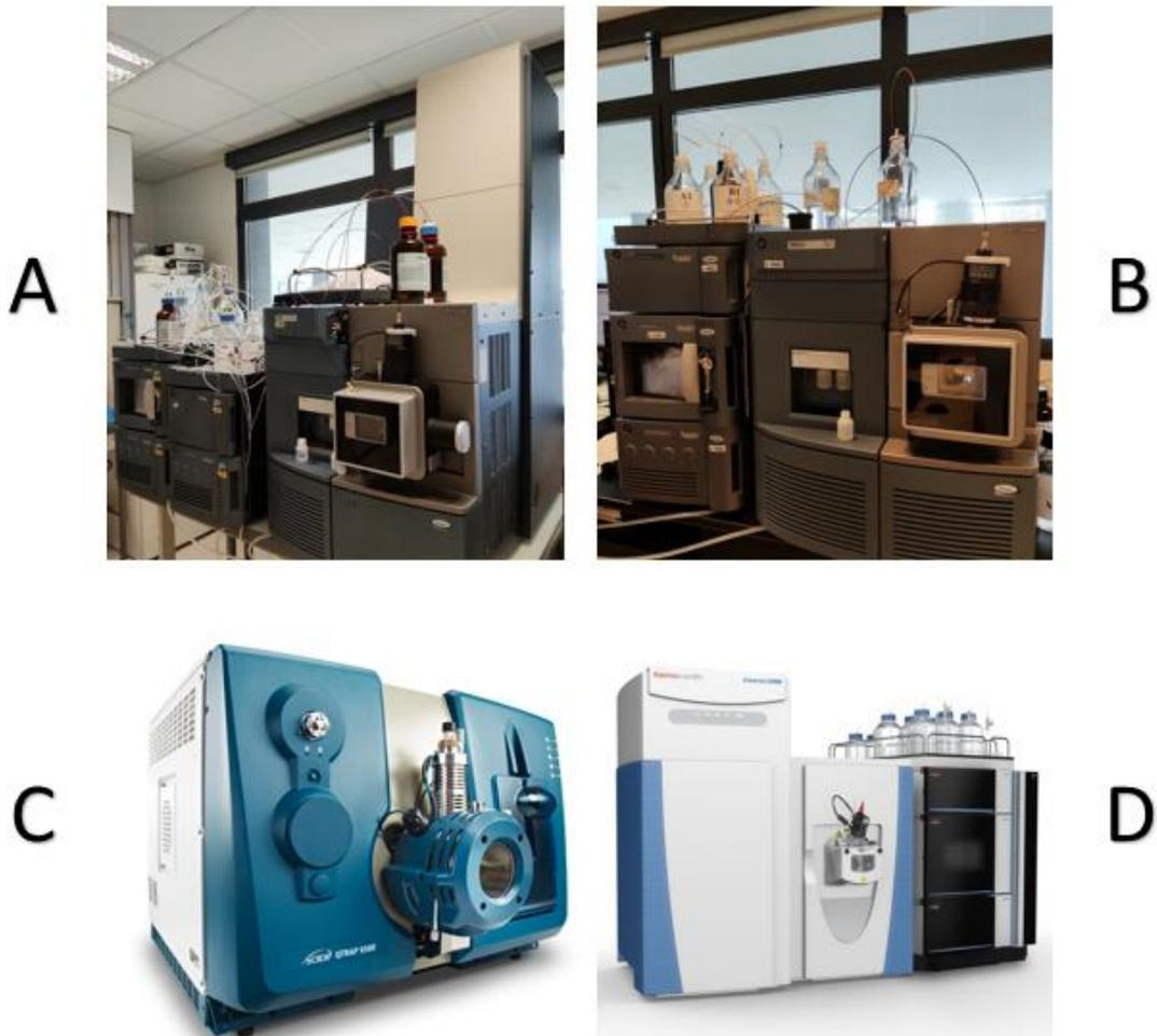
Figure 6 : Les appareils pouvant être utilisés pour le dosage des endocannabinoides. (A) Waters XEVO® qTOF-XS ; (B) Waters XEVO TQ-S ; (C) Sciex Qtrap 6500+®, crédit photo du fabricant (115); (D) Thermofisher Q Exactive® UHRM Hybrid Quadrupole-Orbitrap crédit photo du fabricant (116).
