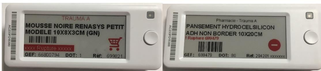
Figure 20. Étiquettes électroniques testées
