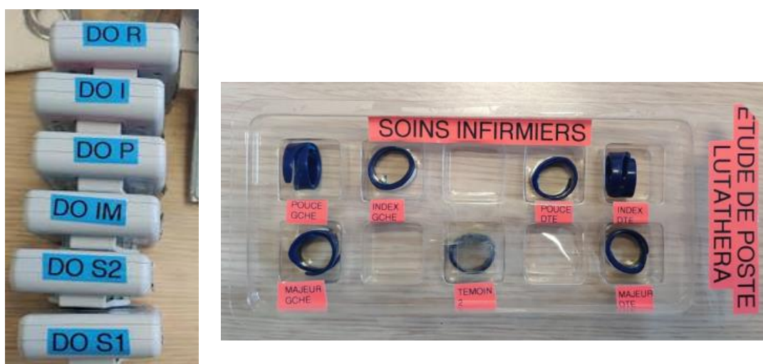
Figure 20 : dosimètres opérationnels (à gauche) et dosimètres bagues du poste « soins infirmiers » (à droite) utilisés pour l'étude de poste
