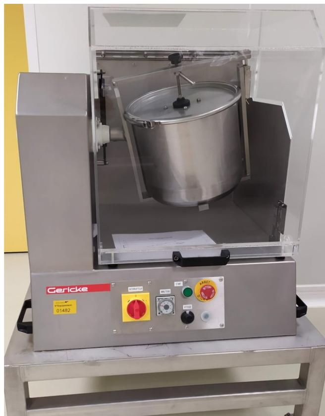
**Figure 23** : Mélangeur Gericke® pilote à retournement avec cuve cylindrique (Laboratoire Biocodex - unité pilote).
