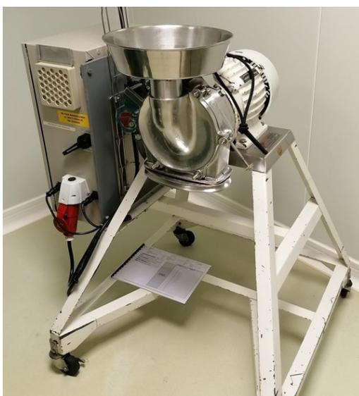
**Figure 22** : Broyeur marteaux/couteaux Fitzmill® (Laboratoire Biocodex - unité pilote).
