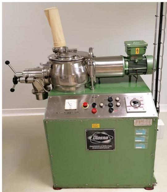
**Figure 21** : Granulateur à haut taux de cisaillement Diosna® (Laboratoire Biocodex - unité pilote).
