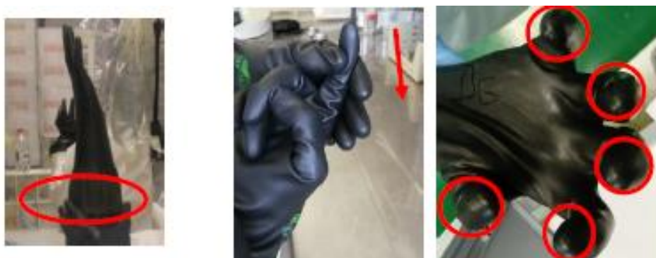
Figure 37: Photos illustrant le contrôle des doigts
