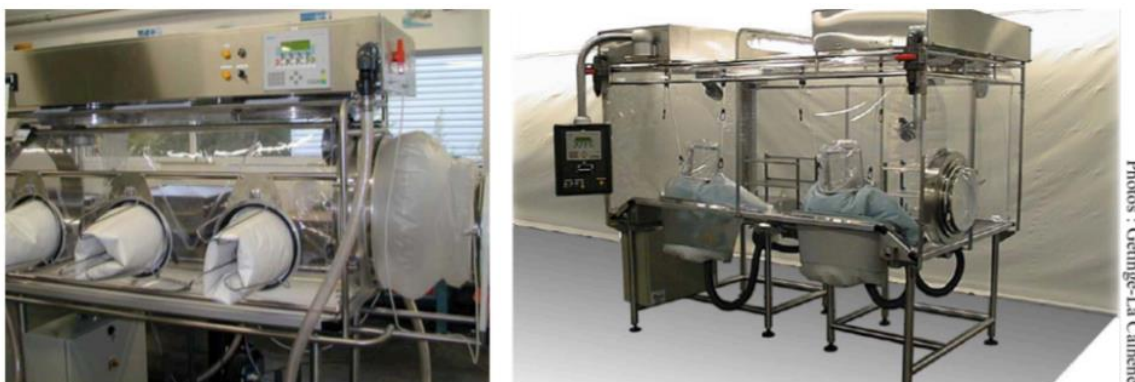
Figure 19 : Isolateur souple à trois gants (gauche) - Isolateur rigide à deux hémi-scaphandres (droite)
