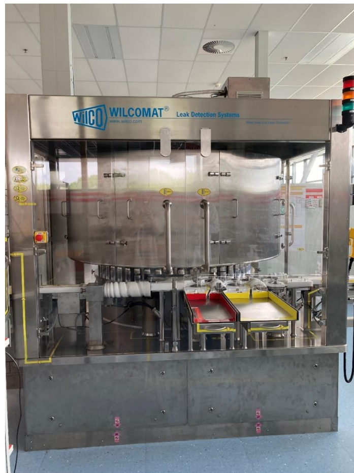
Figure 31 : Photo de la machine de test d'étanchéité (source : photo prise par l'auteur chez GSK Saint-Amand-les-Eaux en juin 2021)
