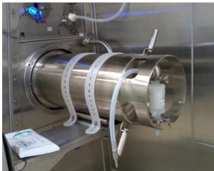
Figure 11: Photo d'un DPTE connecté à un isolateur (source : photo prise par l'auteur chez GSK Saint-Amand-les-Eaux en aout 2021)
