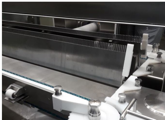
Figure 17 : porte de chargement fermée avec pont levé (source : photo prise par l'auteur chez GSK Saint-Amand-les-Eaux en juillet 2021)
