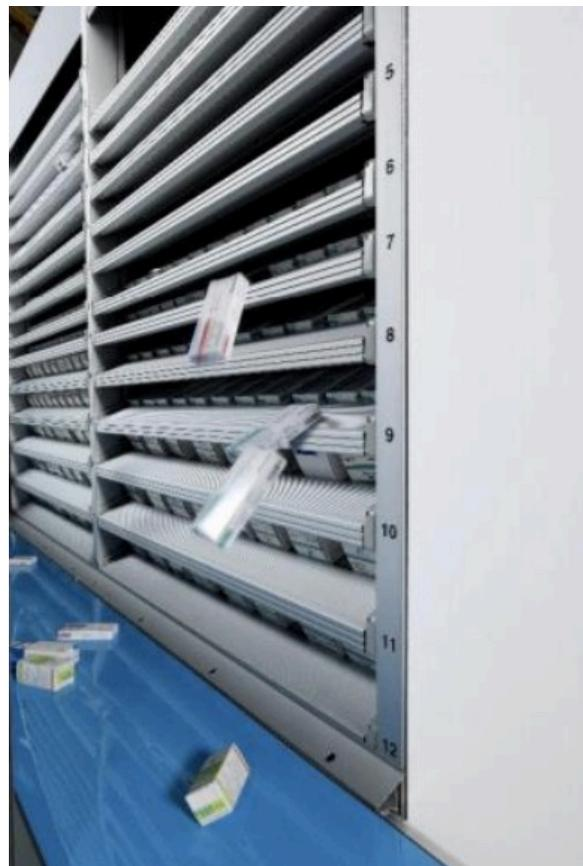
*Figure 2 : Photo montrant le système d'éjection de l'automate Apoteka*
