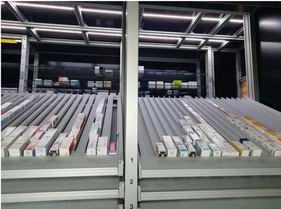
*Figure 4 : Photo montrant les canaux de l'automate Apoteka*
