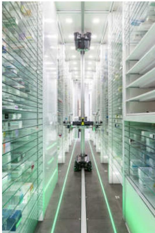
*Figure 18 : Photo montrant l'intérieur du robot Farmabox (19)*
