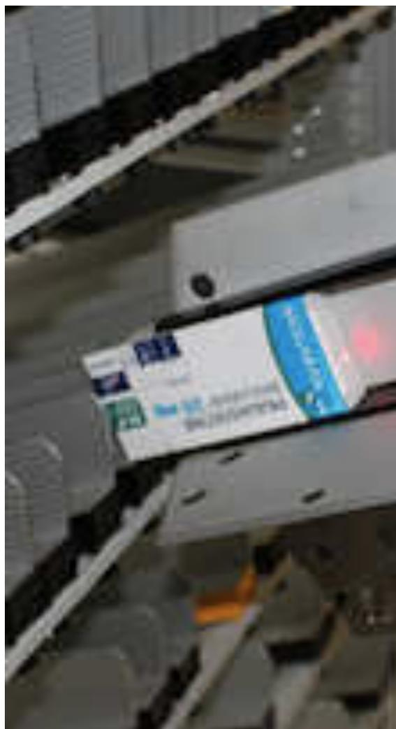
*Figure 27 : Photo du robot Caiman rangeant une boîte dans son automate (33)*
