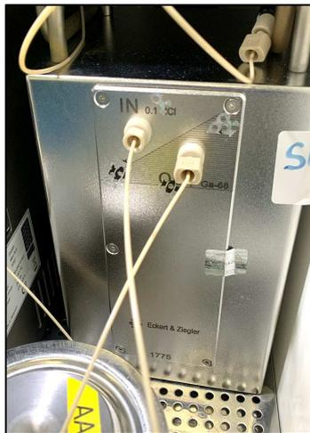
**Figure 10 : Photographie du générateur de  $^{68}\text{Ge}/^{68}\text{Ga}$  du CHU de Lille, placé à l'intérieur de l'enceinte H700**
