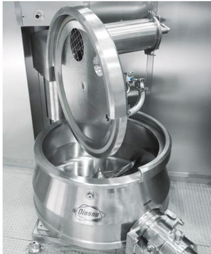
Figure 35 : Photo d'un mélangeur type Diosna (135)
