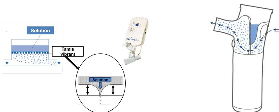
Figure 56 : Photo et schéma d'un nébuliseur à membrane (172)(173)
