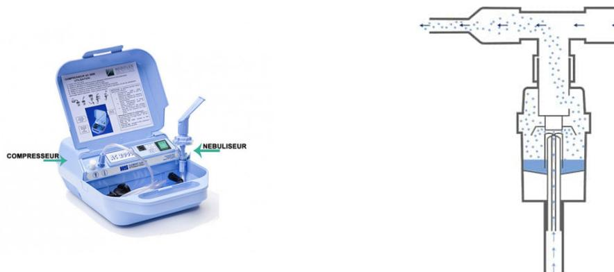
Figure 54 : Photo et schéma d'un nébuliseur pneumatique (168)(169)
