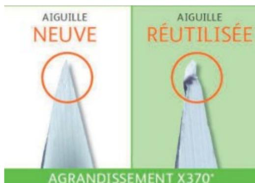
**Figure 38: Aiguilles neuve et réutilisée**
