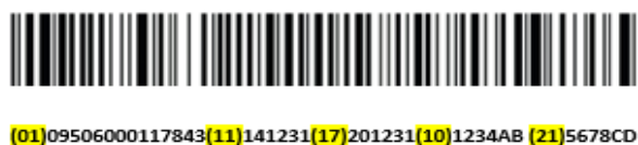
Figure 1 : Code-barres linéaire codé selon la norme GS1
