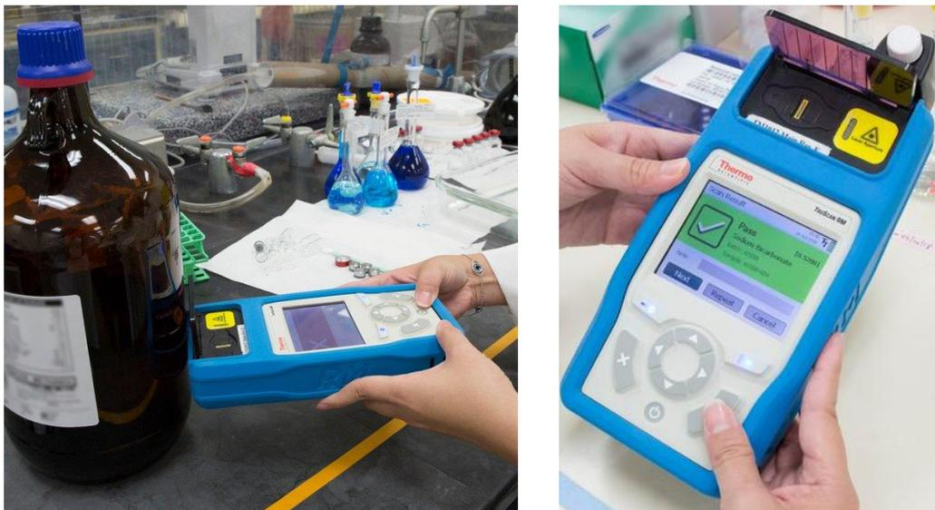
Figure 34 : Exemple d'utilisation du TruScan ([www.thermofisher.com](http://www.thermofisher.com)) (110)
