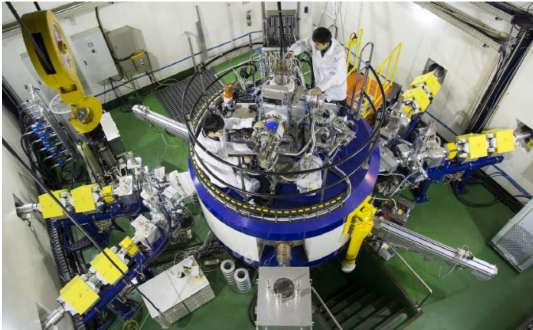
Figure 7 : Le cyclotron RFT-30, un accélérateur de particules de l'Institut coréen de l'énergie atomique. Les techniciens nucléaires ont réussi à utiliser l'équipement pour produire du cuivre (Cu)-67
