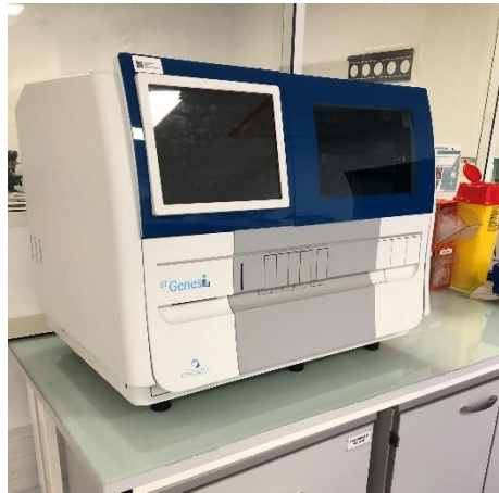
Figure 14 – L'automate ST-Genesis® de la société Diagnostica Stago
