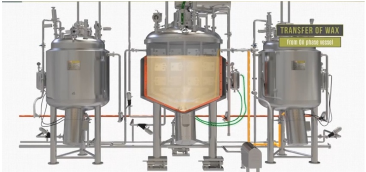
Figure 71 : Transfert de la phase huileuse vers la cuve principale
