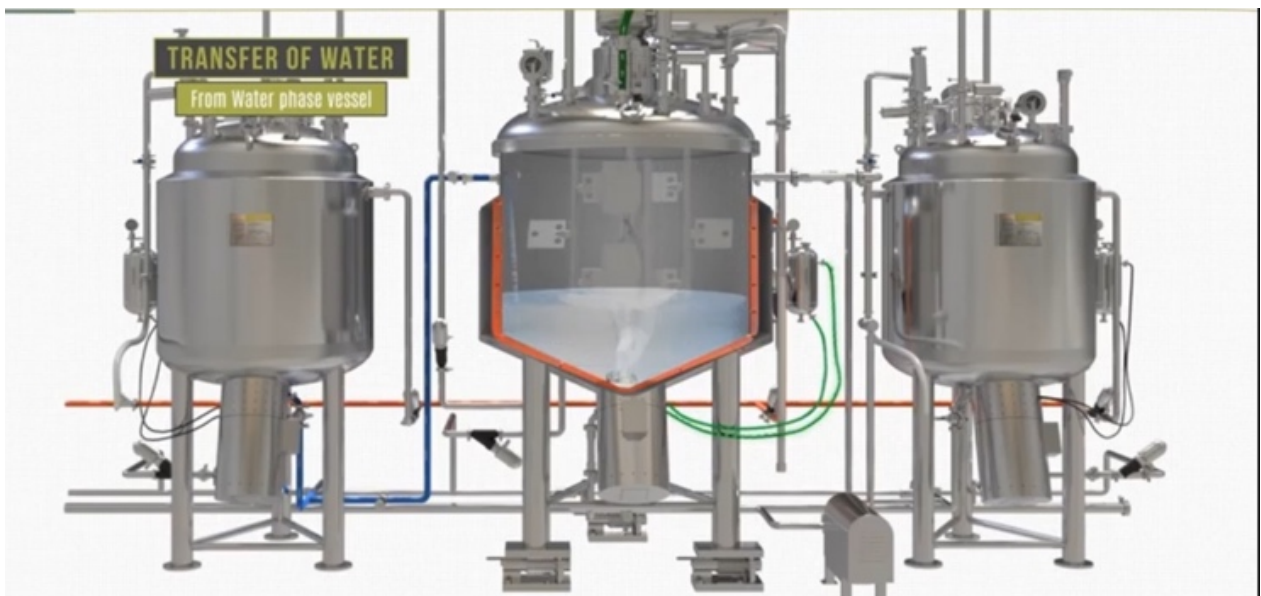
Figure 70 : Transfert de la phase aqueuse vers la cuve principale
