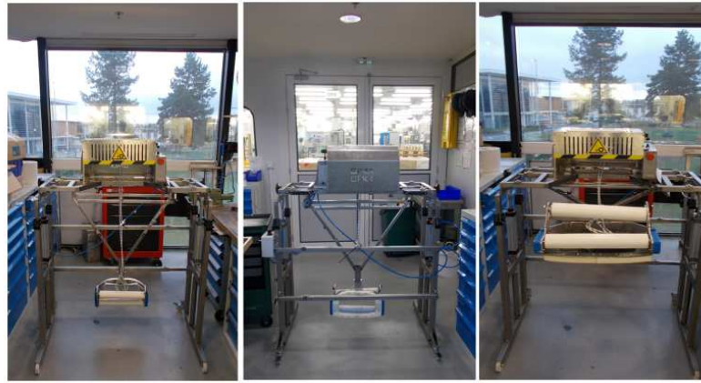
Figure 53 : Essoreuse Pusa Pack (prototype 1) non fixée au container
