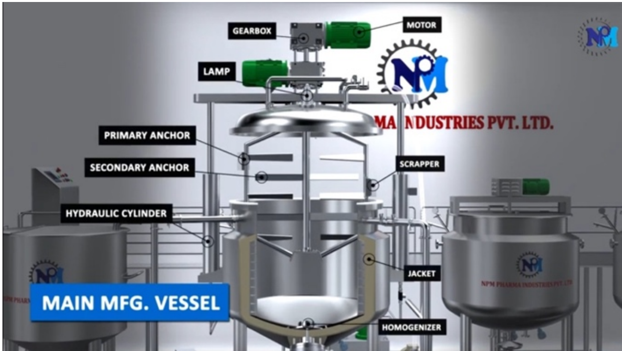
Figure 69 : Cuve principale détaillée
