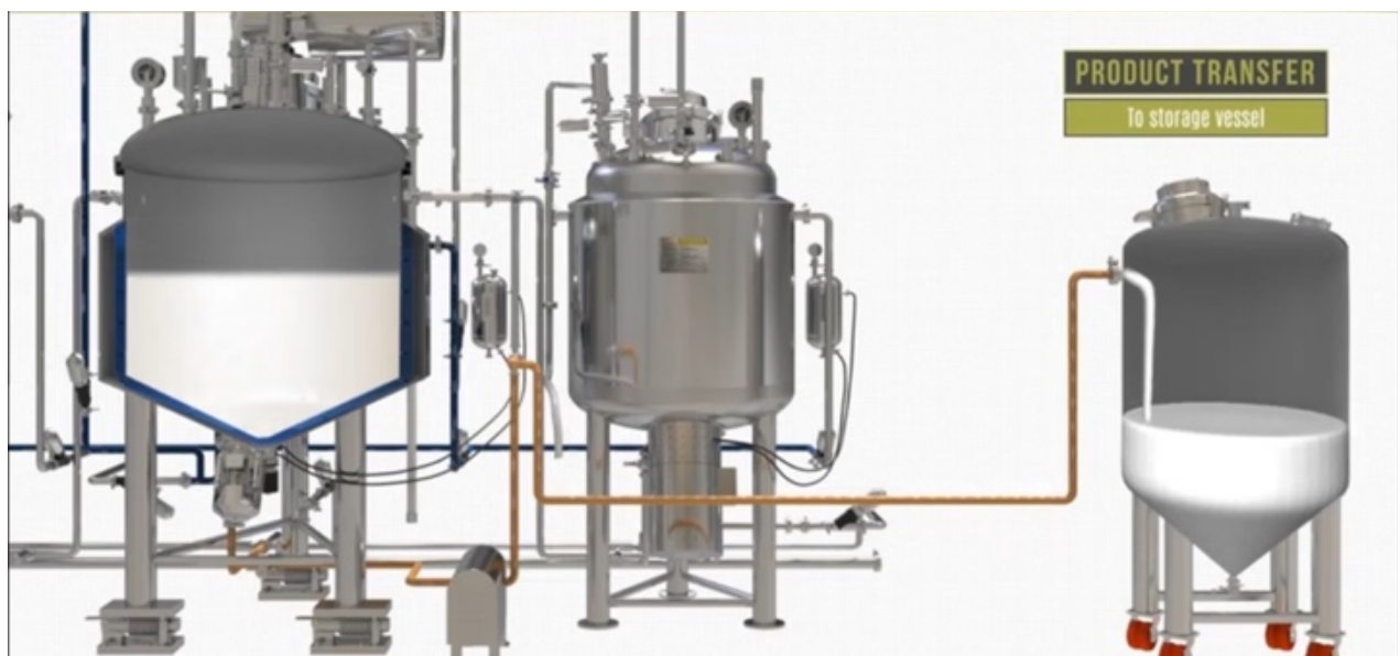
Figure 76 : Transfert vers la cuve mobile pour amener le produit en ligne de conditionnement ou en zone de stockage
