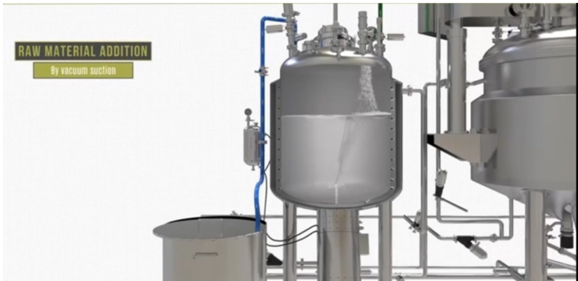
Figure 65 : Remplissage de la cuve de la phase aqueuse
