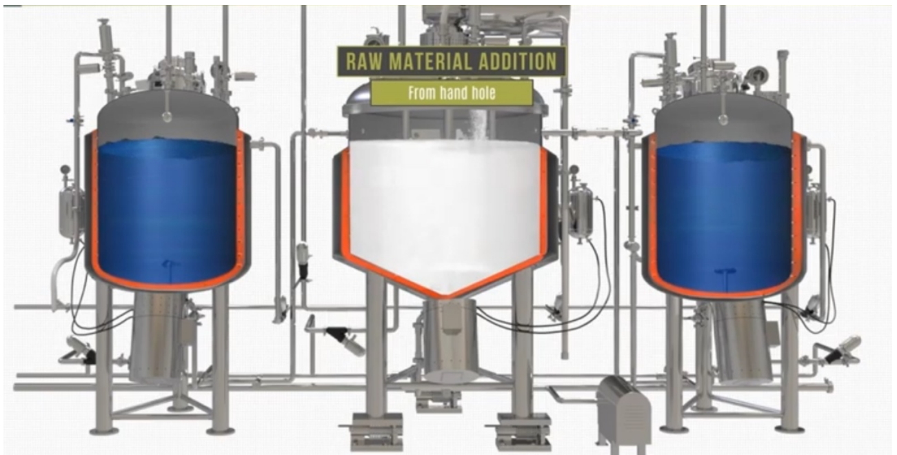
Figure 72 : Ajout des matières premières ne nécessitant pas de préparation en cuves séparées
