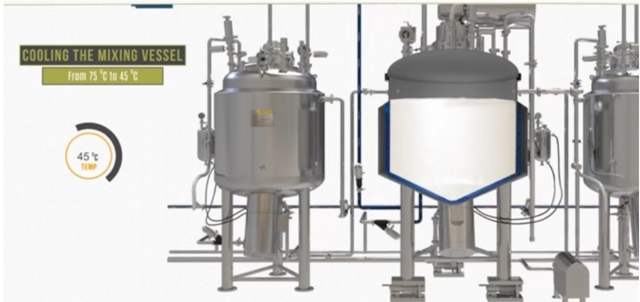
Figure 75 : Refroidissement progressif de la cuve
