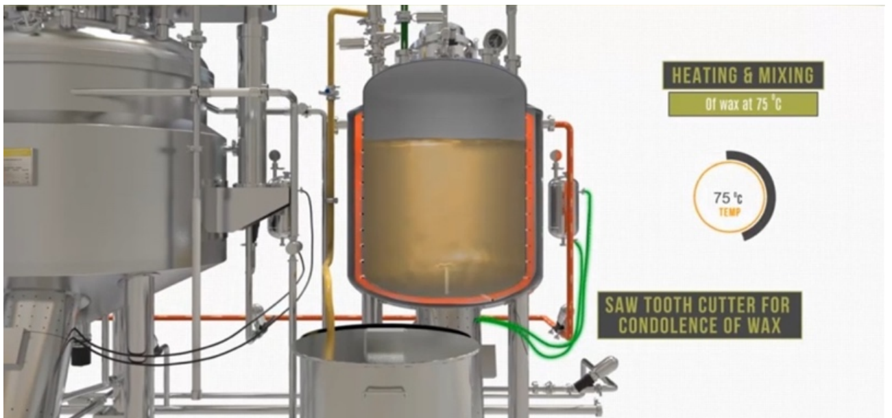
Figure 68 : Agitation de la phase huileuse à 75°C
