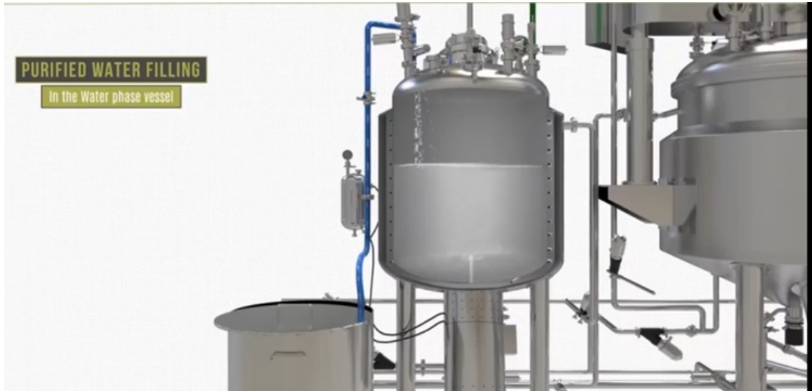
Figure 64 : Remplissage de la cuve de la phase aqueuse
