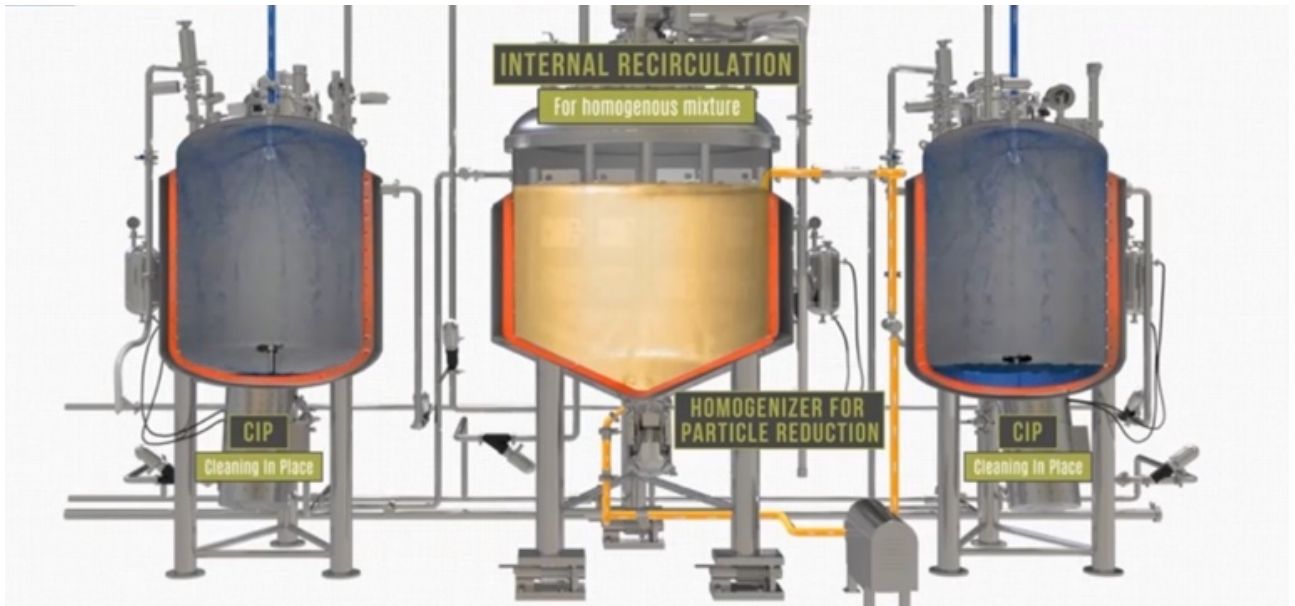
Figure 73 : Mélange des phases avec recirculation interne et homogénéisation pour réduire la taille des particules
