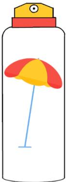
Le récipient, appelé bouteille, doit pouvoir résister à la déformation que pourrait induire la présence de gaz propulseur. Il est souvent en métaux légers et qui résistent à la pression (fer blanc, aluminium). Il contient à la fois le photoprotecteur topique et un gaz propulseur sous forme liquéfiée ou comprimée (butane, isobutane, propane, éther diméthylque,..).
