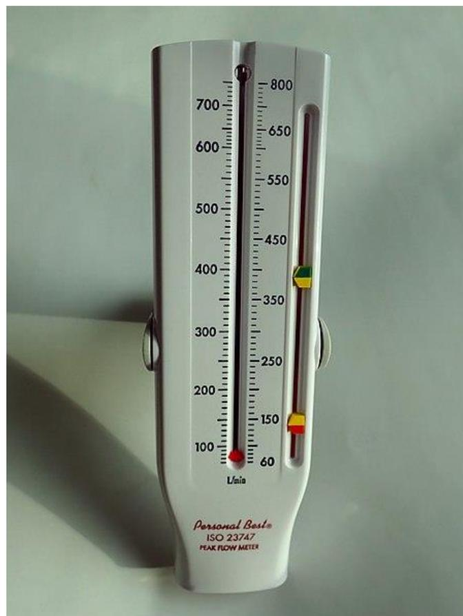
Figure 3 Débitmètre de pointe, Peak Flow, appareil de mesure du DEP (20)
