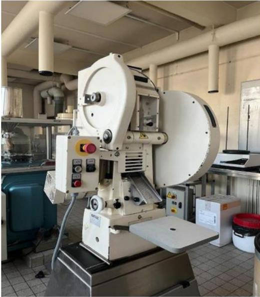
Figure 34. Presse à comprimés automatique KORSCH EKO-DMS, utilisée pour fabriquer les mini-comprimés de 5 mm de diamètre.
