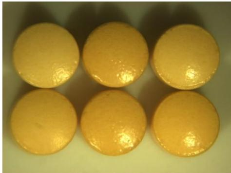
Figure 43. Comprimés enrobés de la formulation Shellac-Inuline aux ratios suivant : 70-30, 80-20, 90-10 (de gauche à droite).
